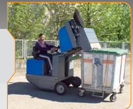
مجهز به جک هیدرولیکی جهت تخلیه آسان مخزن زباله
