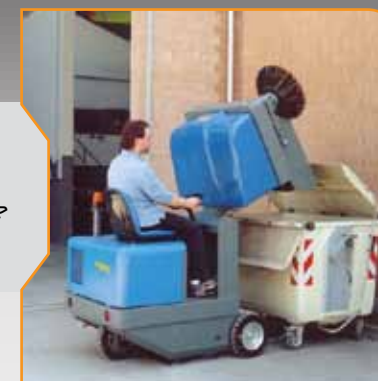
مجهز به جک هیدرولیکی جهت تخلیه آسان مخزن زباله
