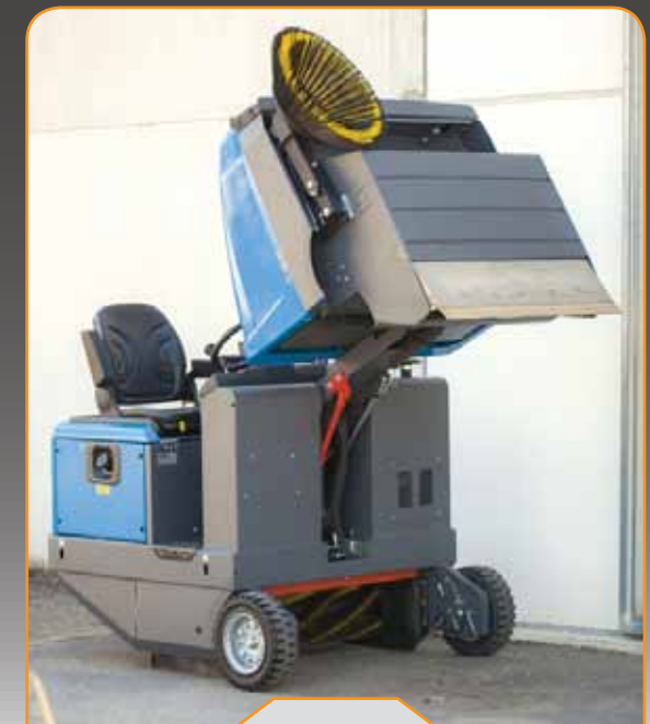
مجهز به جک هیدرولیکی جهت تخلیه آسان مخزن زباله
