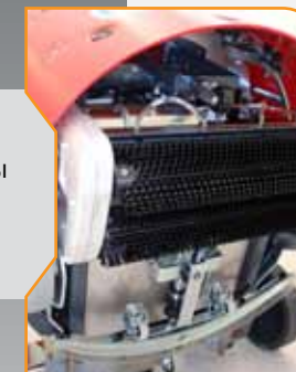
امکان استفاده از انواع برس ها با توجه به جنس کف
