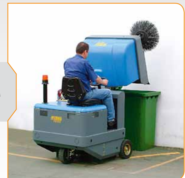
مجهز به جک هیدرولیکی جهت تخلیه آسان مخزن زباله
