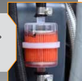
مجهز به فیلتر در قسمت ورودی آب به دستگاه
