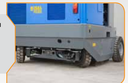
انتقال قدرت به چرخهای عقب به صورت هیدرواستاتیک فرمان هیدرولیک بر روی چرخهای عقب
